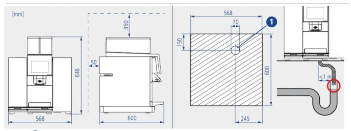
1 Диаметр отверстия 70 мм для ввода воды / молока и выхода дренажа.
